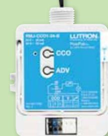
**El módulo de salida de contacto seco PowPak** se integra al sistema HVAC u otro equipo externo a través de contactos secos, lo cual permite al equipo responder a los comandos inalámbricos (montados en el techo)
