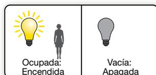
**Los sensores de presencia** apagan las luces e interrumpen la energía inactiva en espera de los electrodomésticos cuando alguien se retira del lugar.
